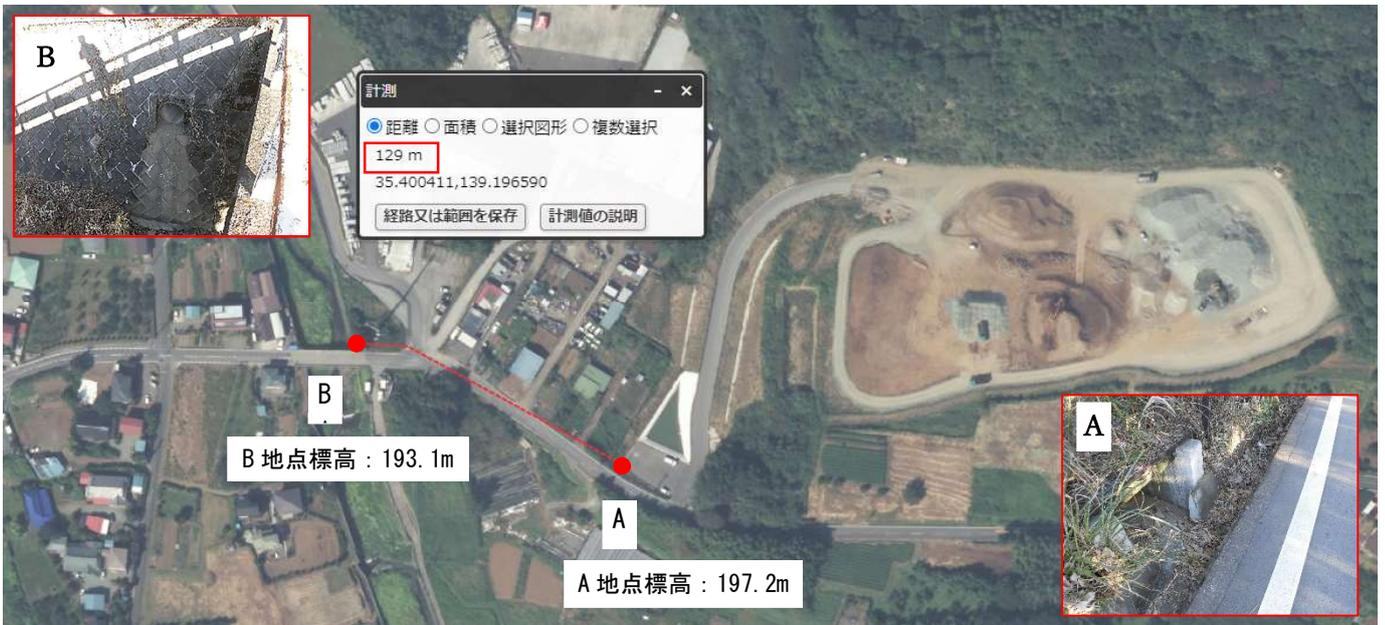
図5-11 国土地理院による2点間の距離計測の結果
