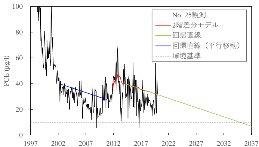
図 2-81 監視基準井戸 (No. 25) における PCE 濃度の変化と回帰直線
