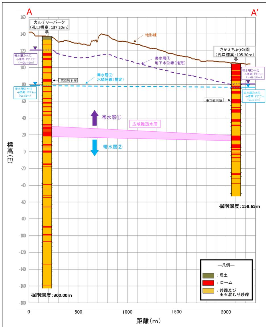
図 2-12 地下水分布断面図 (A-A' 断面)
