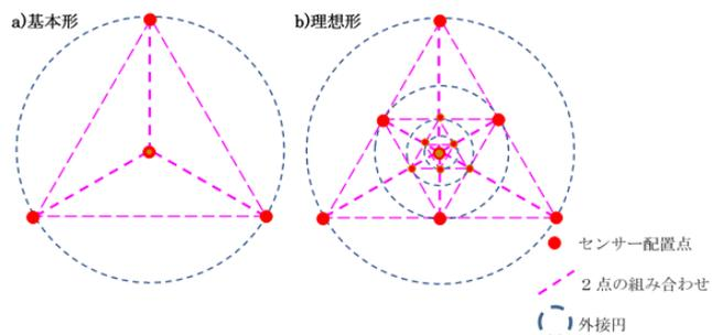
図 2-18 微動アレイ探査正三角形配置
