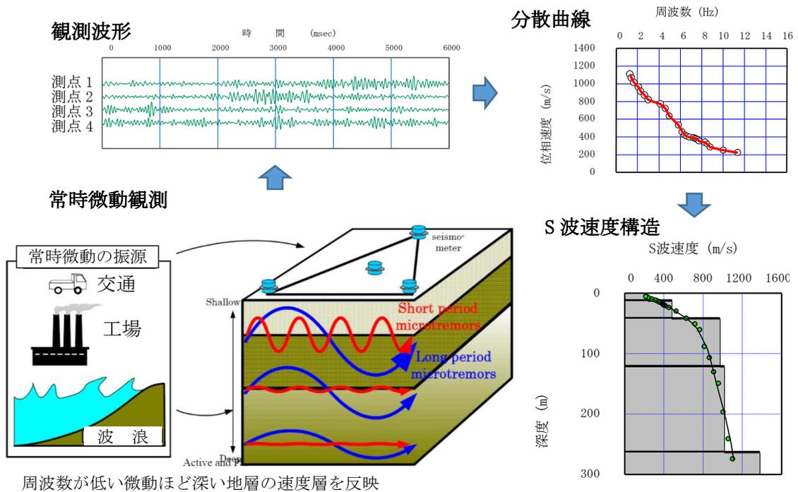
図 2-17 微動アレイ探査の測定概念図
