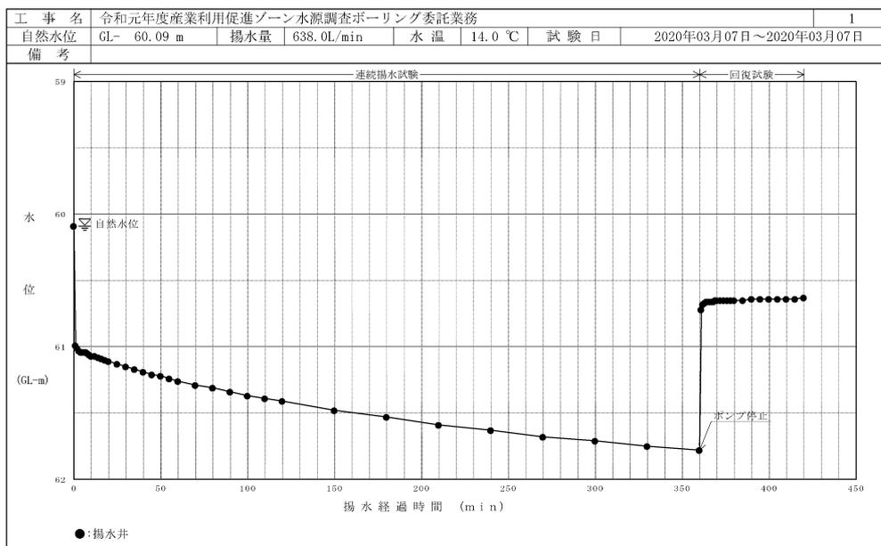
図 2-16 井戸内水位の経時変化図（定量揚水試験）
