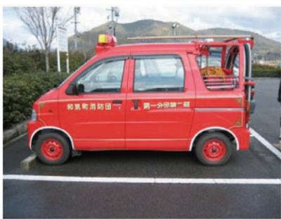
軽自動車型の可搬ポンプ積載車(岡山県和気町HPより)
