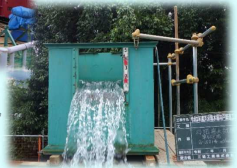
掘削後の井戸の洗浄及び揚水試験
