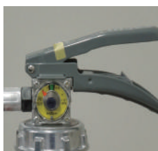
× 安全栓の脱落
