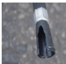
× ノズルの破損
