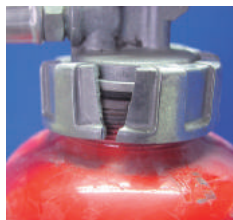
× キャップの破損
