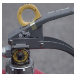
× 表示装置の脱落
