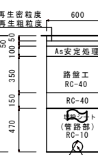
標準埋戻断面図 S=1/25
