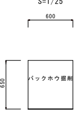
標準掘削断面図 S=1/25
