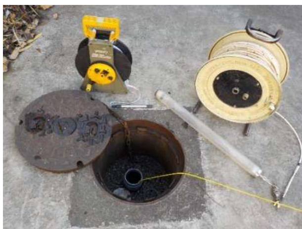
図 4-16 監視基準井戸 （井戸、水位計、採水器）
