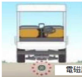
▲電磁誘導線による自車位置特定による運行の補助
